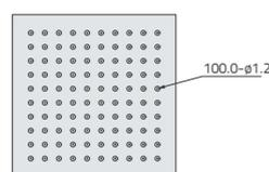
Soffione Slim 200x200 mm sp.2 mm in acciaio c/snodo e anticalcare.
