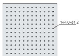
Soffione Slim 300x300 mm sp.2 mm in acciaio c/snodo e anticalcare.
