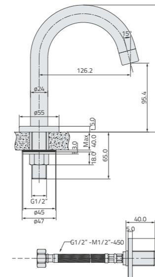
Erogatore per lavabo con flessibile di connessione 1/2" e rosetta.
