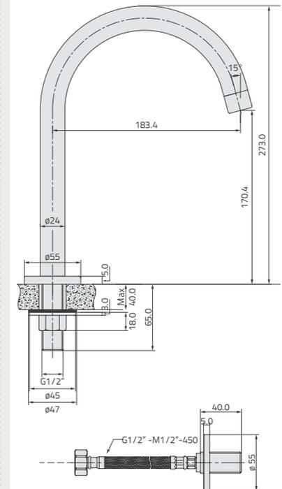
Erogatore per lavabo alto con flessibile di connessione 1/2" e rosetta.
