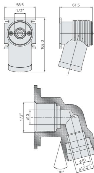
Raccordo terminale curvo estraibile 12x1/2" F ad innesto rapido completo di box di fissaggio.
