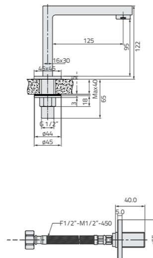
Erogatore per lavabo con flessibile di connessione 1/2" e rosetta.
