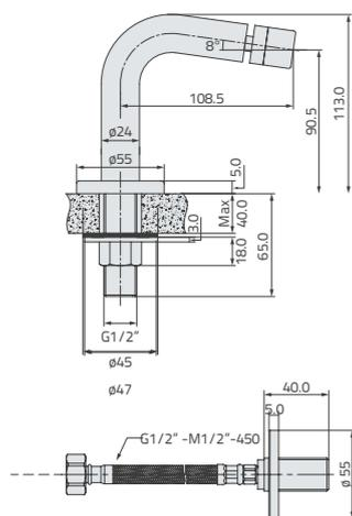
Erogatore per bidet con flessibile di connessione 1/2" e rosetta.
