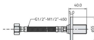
Erogatore per lavabo con flessibile di connessione 1/2" e rosetta.
