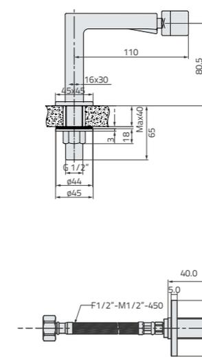
Erogatore per bidet con flessibile di connessione 1/2" e rosetta.
