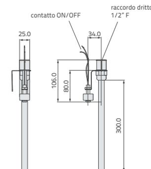
Galleggiante elettronico con contatto on/off / *Electronic float with on/off contact*
