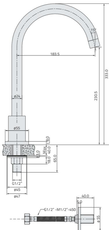
Erogatore per cucina girevole con flessibile di connessione 1/2" e rosetta.
