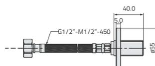
Erogatore per lavabo alto con flessibile di connessione 1/2" e rosetta.
