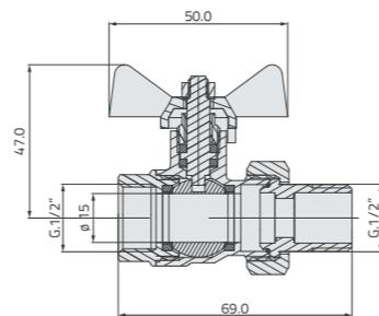
Valvole a sfera 1/2" M/F c/bocchettone per attacco acqua calda e fredda.
