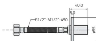
Erogatore per bidet con flessibile di connessione 1/2" e rosetta.
